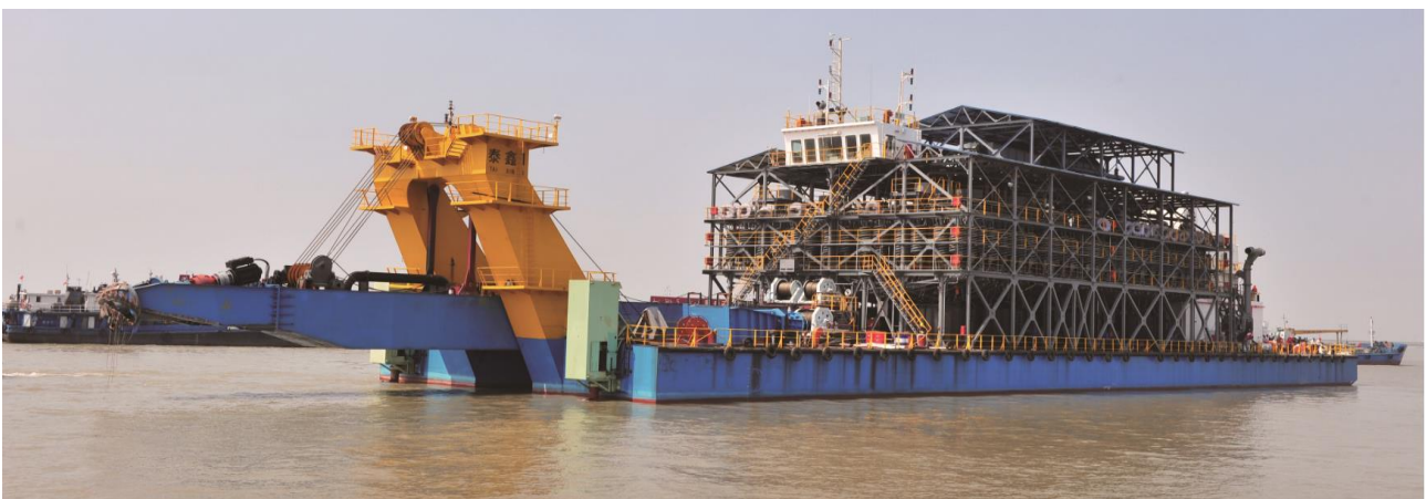
Figura 4 - Exemplo de barco de mineração utilizado na mineração de areias pesadas
